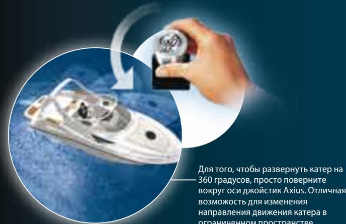
Для того, чтобы развернуть катер на 360 градусов, просто поверните вокруг оси джойстик Axius. Отличная возможность для изменения направления движения катера в ограниченном пространстве.
